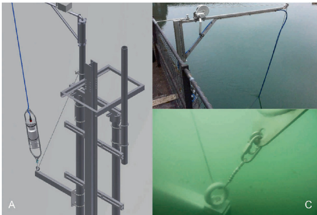
Abbildung 3: Plan der Installation einer Wassersonde an einem im Wasser stehenden Pfeiler (A); ein am Ufer befestigter Galgen (B); untere Befestigung der Sonde (C). Über den Galgen werden das blaue Anschlusskabel und das tragende Stahlseil ins Wasser geführt. Das untere Stahlseil dient zur Positionierung und Sicherung der Sonde. (Bild A: D. Wyder, Metas; Bild C: taf-taucharbeiten ag).
